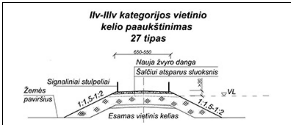
3 pav. 27 tipo profilio rekonstruojamo IIv-IIIv kategorijos vietinio kelio (paaukštinimo) pjūvis
